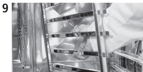
**9** Mettre le cadre   suspendre en place et fixer le tuyau avec le crochet.
