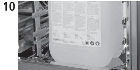
**10** Placer le bidon contenant le liquide de d tartrage dans l'enceinte et introduire le tuyau dans le bidon.
