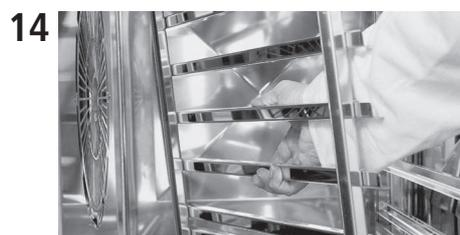
Enlever les accessoires de d etartrage, mettre en place le d eflecteur et le cadre   suspendre   gauche et verrouiller.
