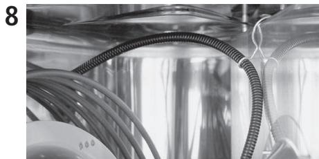
**8** Introduire le tuyau dans l'orifice d'entr e de la vapeur jusqu'  la marque indiqu e.
