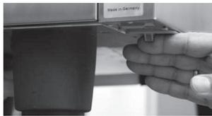
Enfoncer le levier vers la gauche pour desserrer le bec d'encliquetage, pousser le filtre vers la gauche et l'enlever vers le bas.
